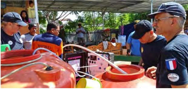
Unité portable de production d'eau potable de 300 litres/heure. Cette unité est autonome avec une alimentation par panneaux photovoltaïques.
